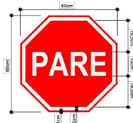
O acabamento final deverá ser feito com pintura eletrostática a pó poliéster, com o mínimo de 50 micra, com secagem a estufa à temperatura de 200 °C, com letras, números, símbolos, orlas e tarjas em película refletiva com esferas inclusas tipo I-B (NBR 14644), exceto na cor preta que deverá ser em película não refletiva tipo IV-B (NBR 14644).
